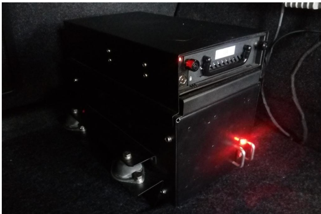
Rys. 8.6. Widok zamontowanej jednostki centralnej w komorze bagażnika pojazdu.
