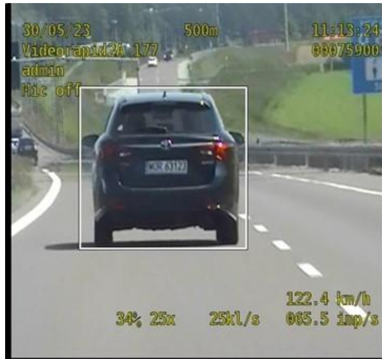
Rys. 5.5. Ramka kontrolna, start pomiaru. Odcinek pomiarowy 500 m.
