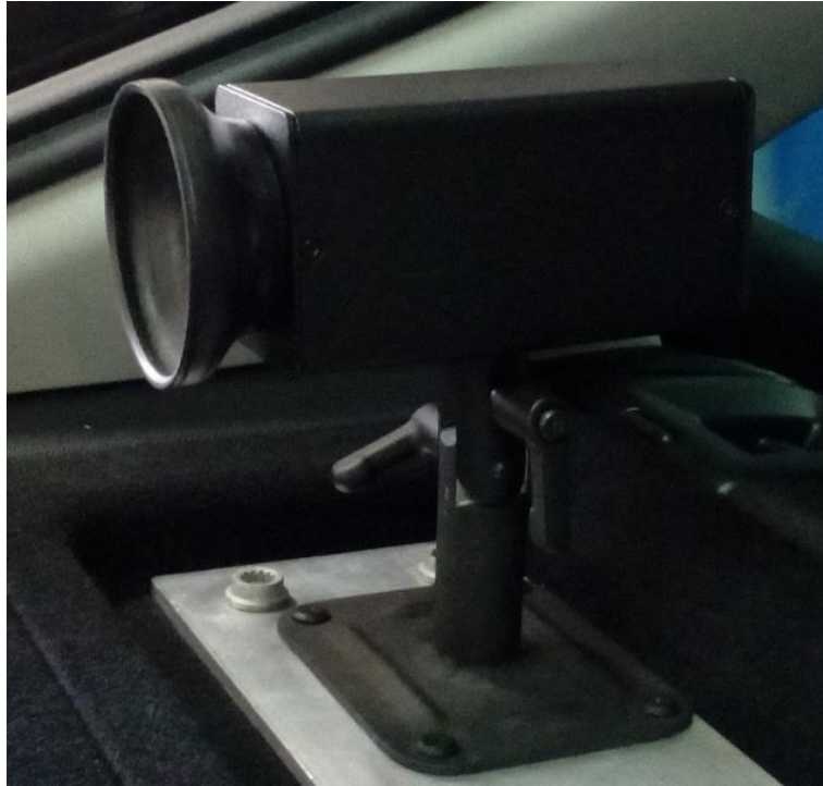
Rys. 3.6. Widok kamery tylnej zamontowanej na wsporniku.
