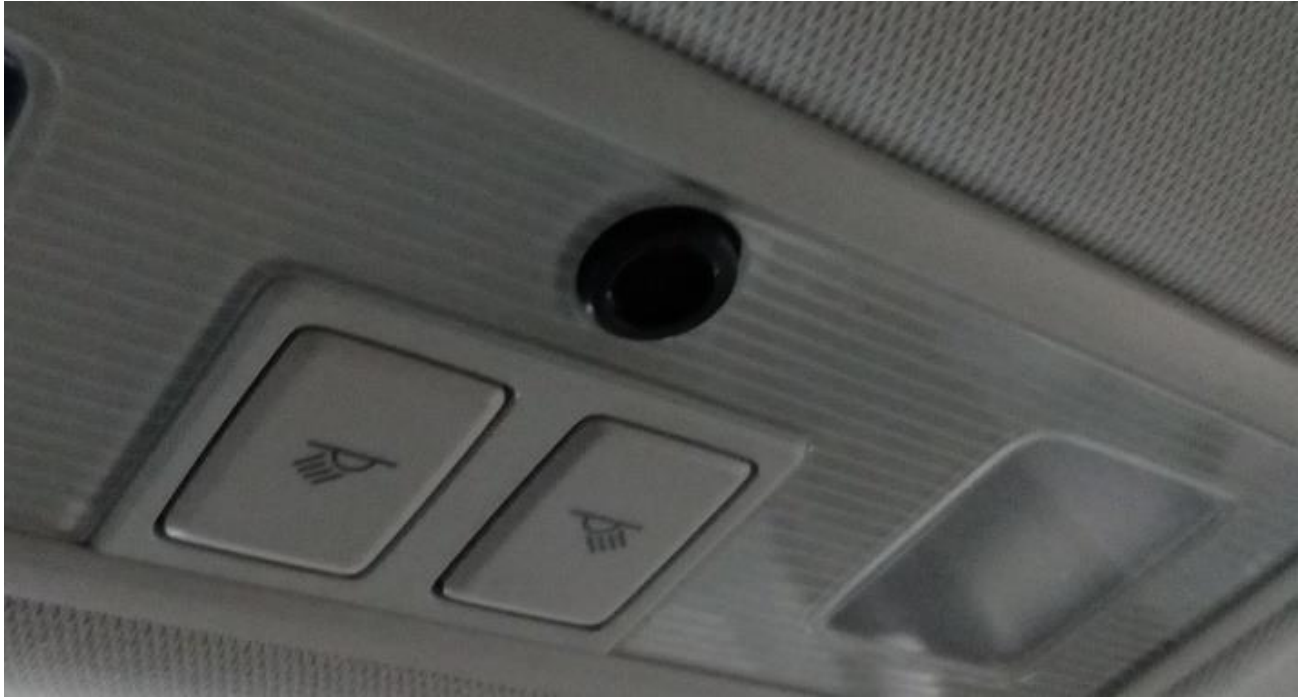
Rys. 8.4. Widok zamontowanego mikrofonu w pojeździe.
