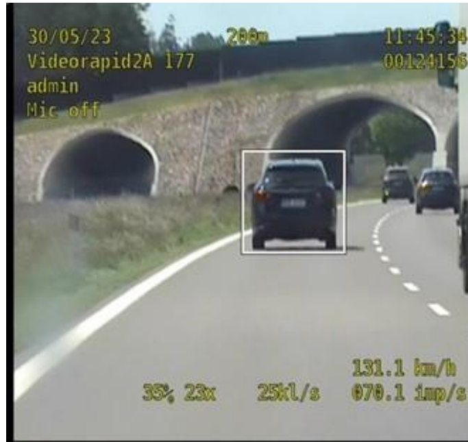
Rys. 5.7. Ramka kontrolna, start pomiaru. Odcinek pomiarowy 200 m.
