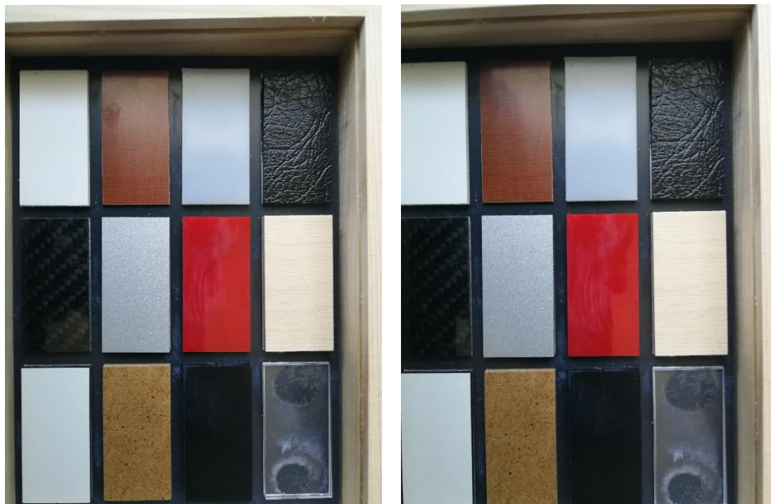
Rys. 1. Porównanie próbek polimerów technologicznych (grupa 3) przed naświetleniem UVC (zdjęcie lewe) i po naświetleniu (zdjęcie prawe).
